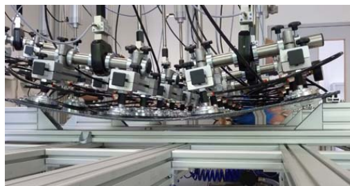
TPedge-Modul, gemeinsame Entwicklung der Bystronic glass und Fraunhofer ISE, bei der mechanischen Lastprüfung ©Fraunhofer ISE
